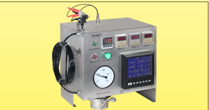
Испытательное оборудование для многократного и постоянного измерения максимальной длины соединительных трубок воздушного выключателя в зависимости от объема кнопки и развиваемого ею давления (лаборатория Ultimheat)
